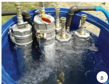
3-р зураг. Чөмгөн (кернийн) дээжинд хий хэмжих багажны ажиллагаа: а. Хий хэмжих багаж, б. Хий хэмжээний дараа хийг агаарт гарган шатааж аюулгүй болгодог. в. Хийг нь хэмжих дээжийн температурыг тогтмол байлгахын тул бортоготой дээжийг усан ваннд тогтмол температурт байлгана.
